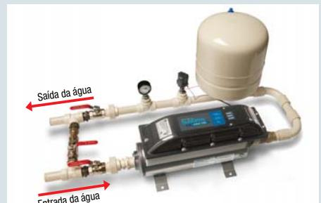
**9** Instale o tanque de pressão e regule a pré-carga do mesmo. Esta deve ser 70 % do valor de pressão regulado no sensor de pressão. Conecte as tubulações externas de sucção (do cavalete até a bomba) e de recalque (do sensor para a residência). Escorre o sistema e pronto!
