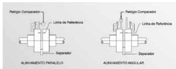
Figura 9 - Alinhamento do acoplamento usando relógio comparador.
