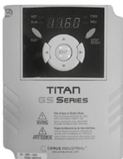
Figura 10 - Função “rEF”: exemplo da alteração do valor da pressão de trabalho
