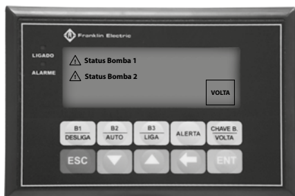
Figura 11: Tela de status das motobombas.
