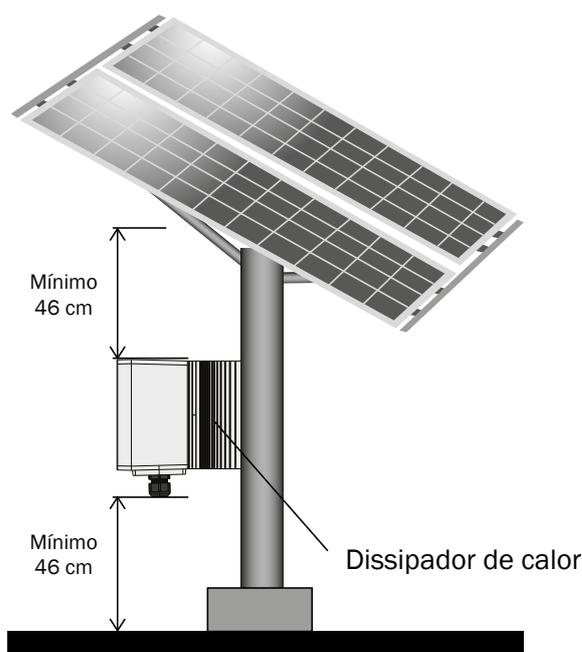
Figura 5: Posicionamento do controlador.
