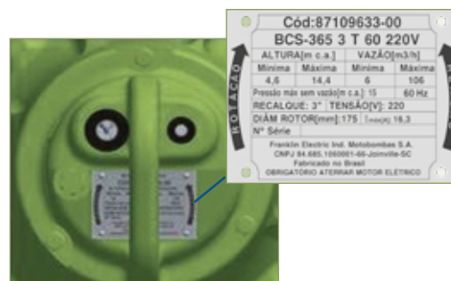
Figura 6 – Plaqueta de identificação da motobomba e sentido de rotação e reação.
