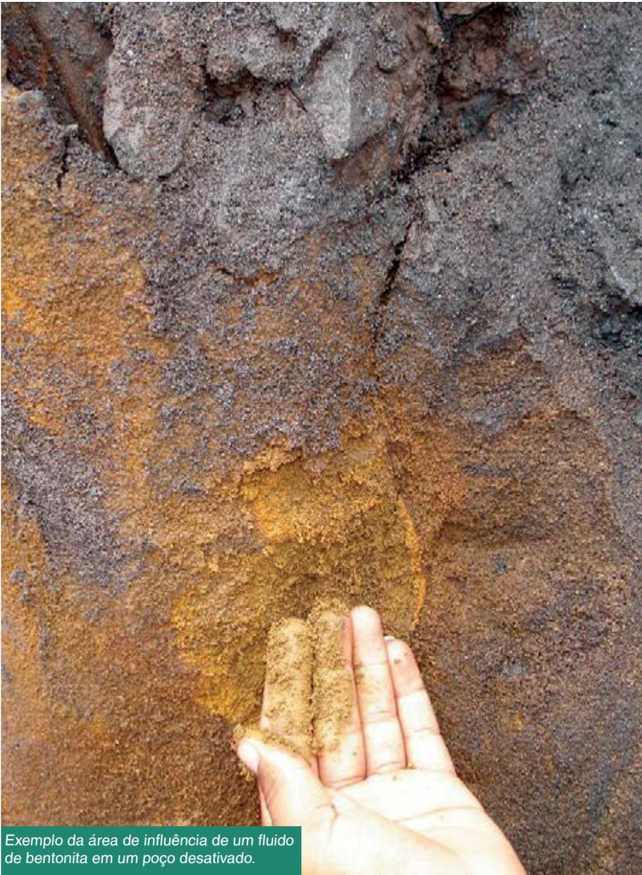
Exemplo da área de influência de um fluido de bentonita em um poço desativado.
